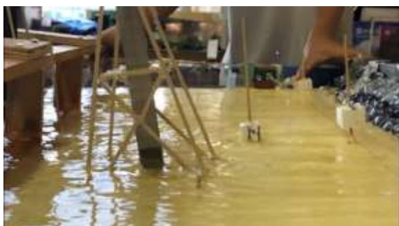
模型の建築物を、波を起し被害を検証している実験
